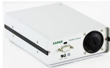
CONTADOR DE RADON, TIPO RADON SCOUT DE SARAD
