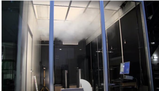
Visualización del patrón de flujo de aire de laboratorio (Fuente: Componentes de Krantz, Aachen, Alemania)
