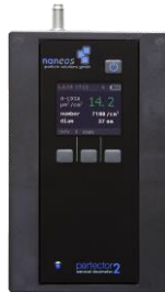
DETECTOR DE NANOPARTÍCULOS MULTIMÉTRICO TIPO PARTECTOR DE NANEOS
